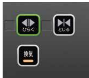
▲操作盤に設置された「換気ボタン」
